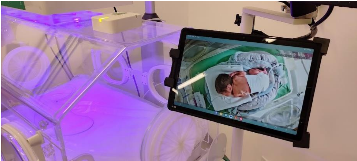
1 ábra: non-kontakt kamera rendszer –adatkoncentrátor integrációval
