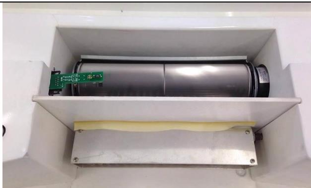
10. ábra az új ventilátor és az új belső érzékelő
